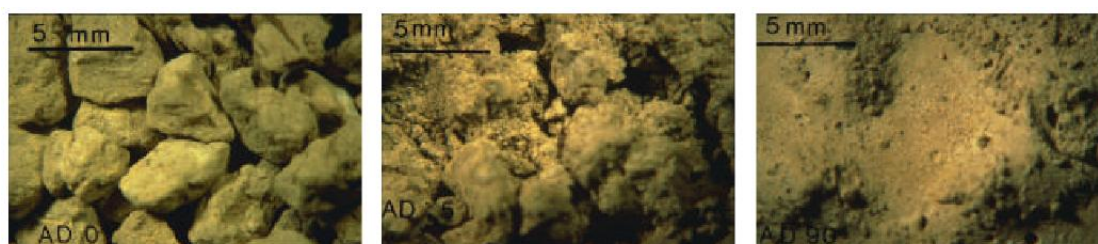
Figure 4 : Différentes étapes de la dégradation structurale sur sol limoneux ( Le Bissonnais et al, 2002 )
