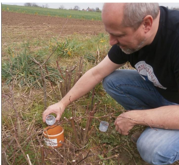
*Photographie 20 : Mesures d'infiltrométrie à Schwindratzheim.*
