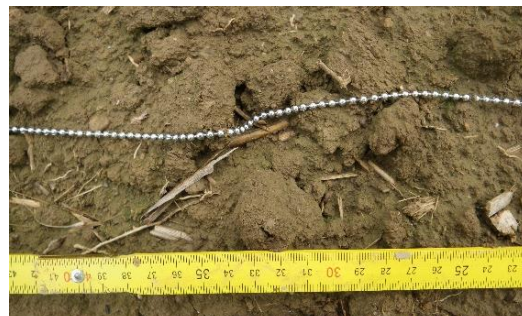
Figure 5. L'exemple de mesure de la rugosité à la chainette (ARAA)
