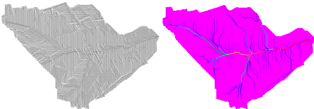
Figure 20. Carte des directions des flux ( ldd.map ), à gauche et carte d'accumulation des flux, accu.map (à droite)
