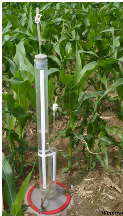
Figure 10 : L'infiltromètre à disque
